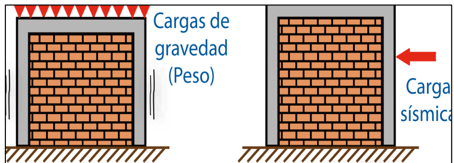
Figura 3. Función estructural del muro portante. Nota. Fuente: Medina, R. (2010).
