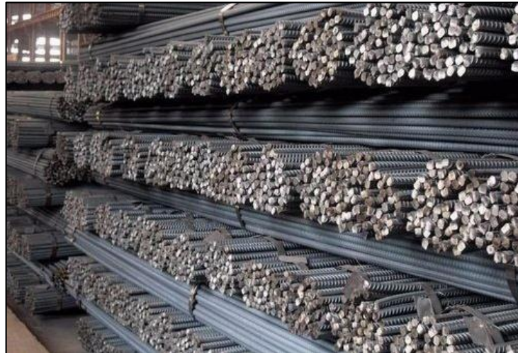
Figura 15. Varillas de acero corrugado almacenados. Nota. Fuente: Martín, B. (2017).
