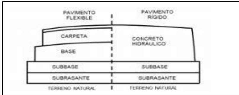
Figura 5; Esquema de estructura de un pavimento rígido.
