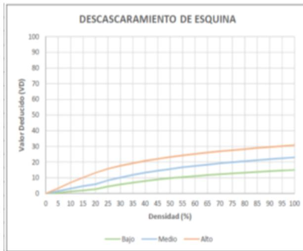
Figura 71; Falla 38 Descascaramiento de esquina
