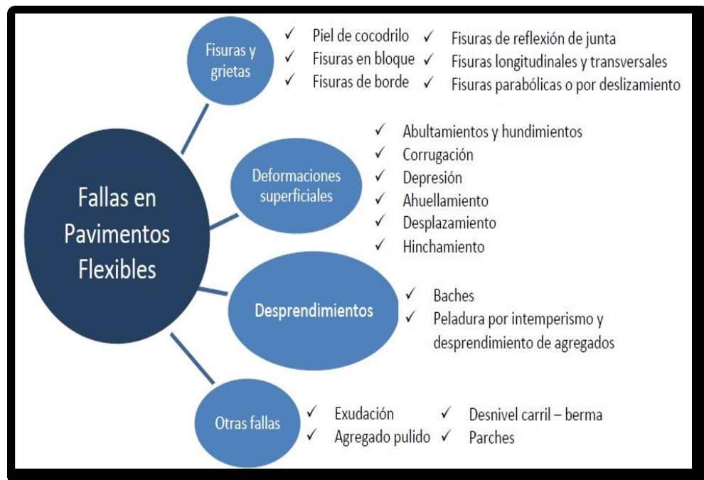
Figura 27: Resumen de Fallas en Pavimentos Flexibles.
