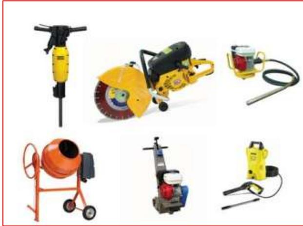
Imagen 36: Maquinaria mínima utilizada en la reparación de espesor parcial.
