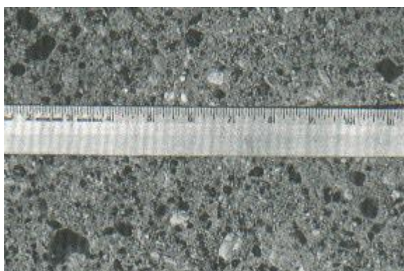
Figura: Pulimiento de Agregado.
